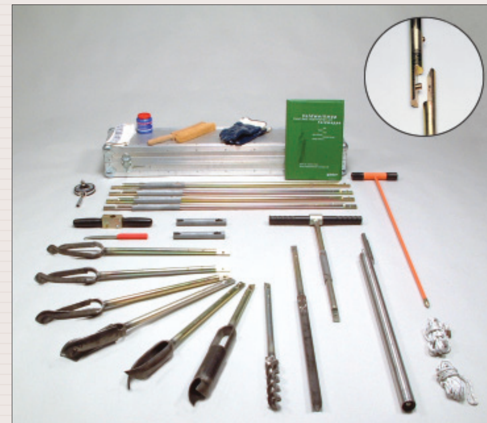
Bohrset für heterogene Böden (Bajonettverbindung)
