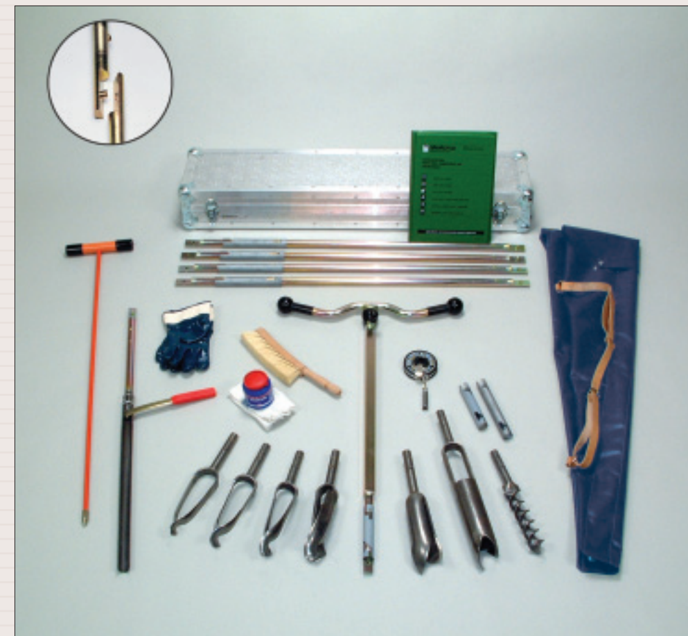
Ergonomisches Bohrset mit Bajonettverbindung
