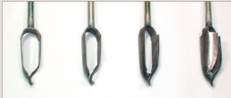
Edelman-Bohrer: Ton, Kombination, Sand und Grobsand.
