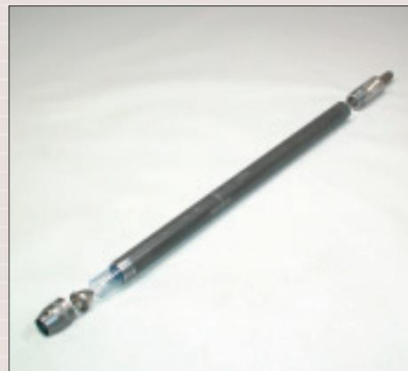
Probennehmer mit Probenrohr
