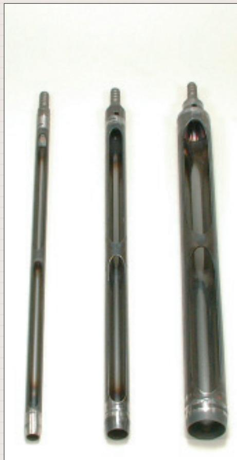
Rammkernsonden mit verschiedenen Durchmessern.
