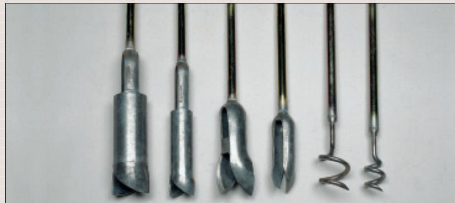
Riverside-Bohrer, Kiesbohrer und Steinfänger
