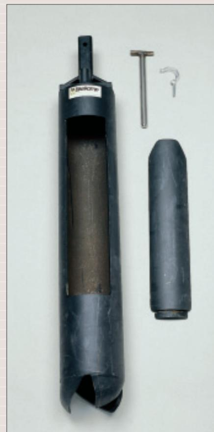
Schwerer Riverside-Bohrer mit Seitenklappe
