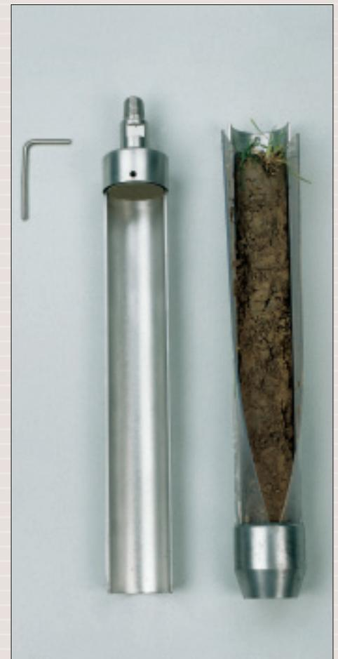
Split-Tube-Probennehmer mit Probe
