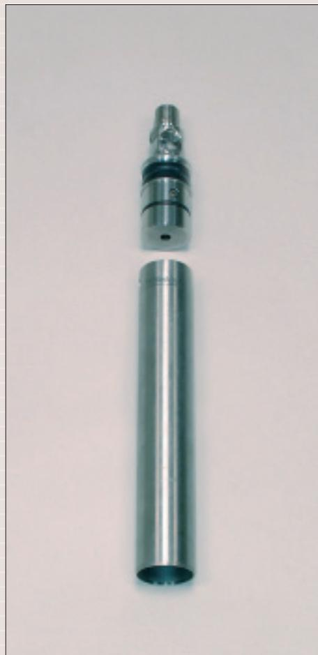
Stechapparat mit Kernproberohr
