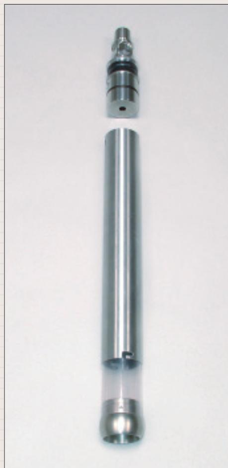
Stechapparat, Probenbüchse und Schneide
