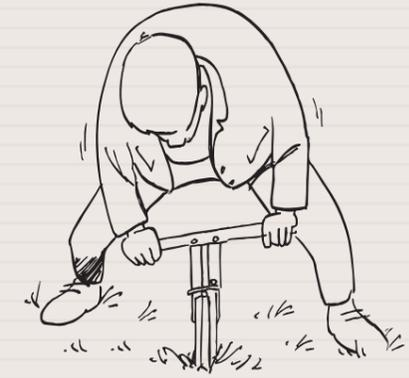
Wenn die gewünschte Tiefe erreicht ist, wird der Profilstecher in eingesteter Stellung aus dem Boden gezogen.
