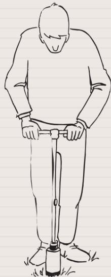
Nach dem Aufbohren des Lochs (um Reibung des Bohrers im Bohrloch zu verhindern) wird der Bohrer mit Hilfe des rückschlagfreien Hammers in den geebneten Boden des Bohrlochs eingeschlagen.
