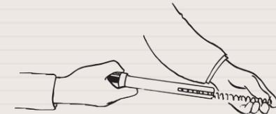
Der Taschenpenetrometer wird zur Bestimmung des Eindringungswiderstandes einer ungestörten Probe benutzt.
