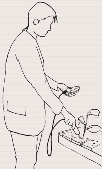
19.33 WET-Sensor, zur direkten Messung des Wassergehalts, der Bodentemperatur und der Leitfähigkeit des Bodens und von Substraten.
