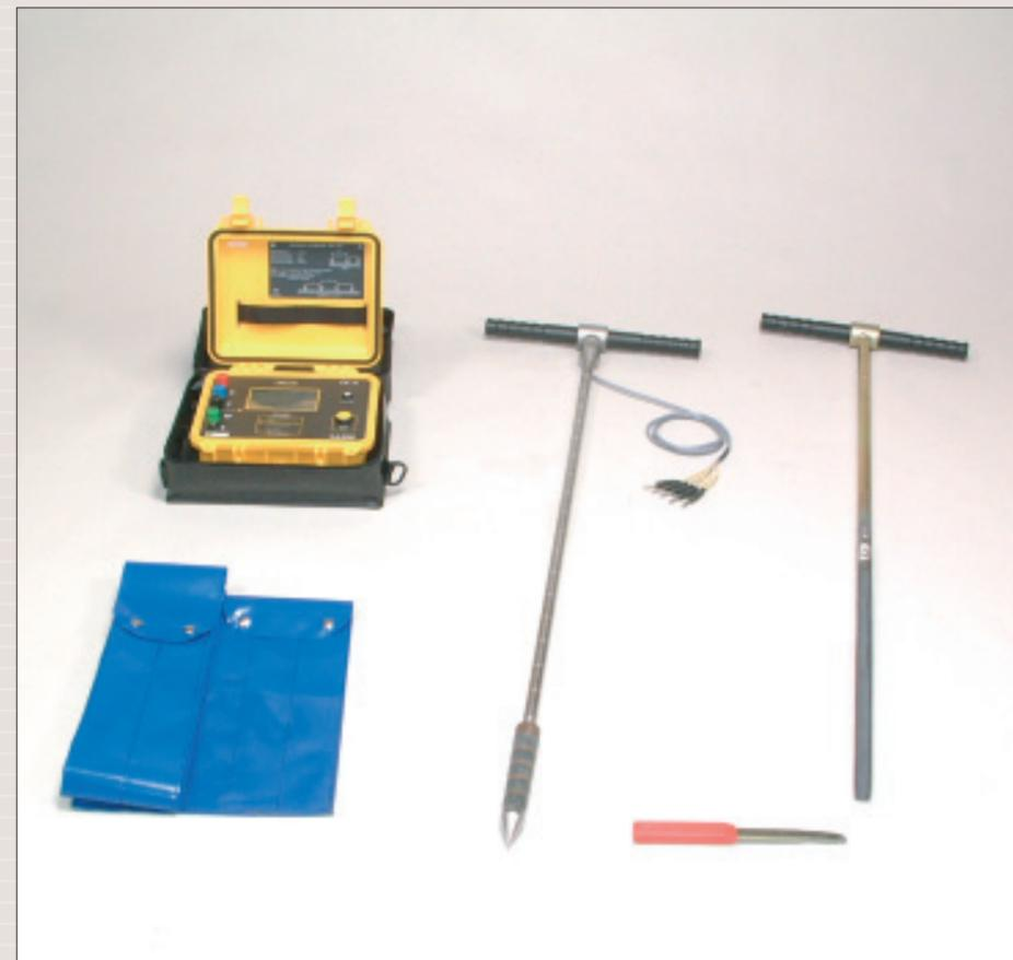
Leitfähigkeitssonde zur Messung der Versalzung des Bodens, Standardset
