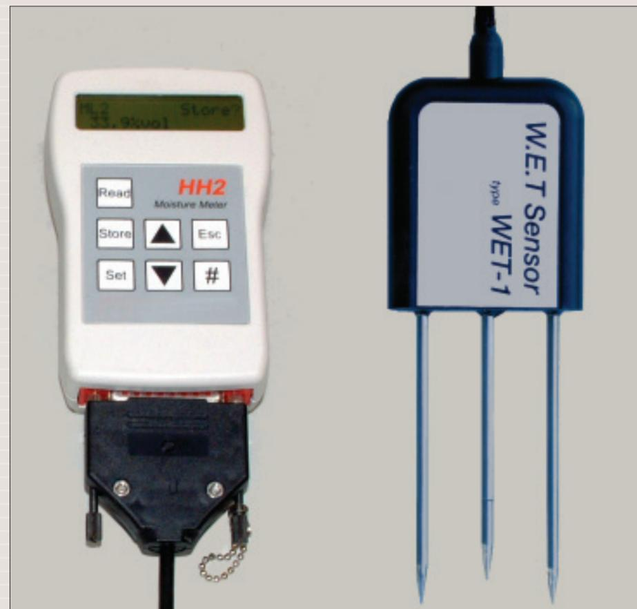
WET-Sensor und Handmessgerät
