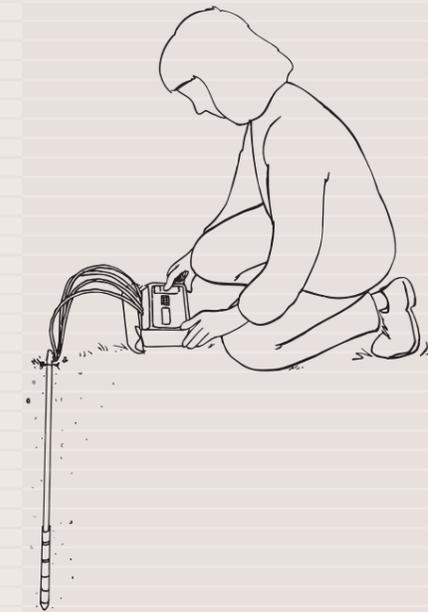
Um Messungen mit der Leitfähigkeitssonde zu ermöglichen, muss dieser richtige Kontakt (= geringer Kontaktwiderstand) mit dem umgebenden Boden haben.
