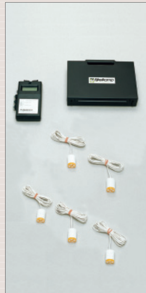
Bodenfeuchtigkeitsmessgerät mit Gipsblöcken
