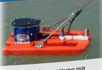
Durchflussmessung mit WinRiver II
