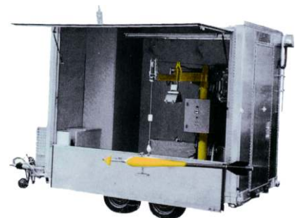
Meßanhänger mit SEW - II mechanisch oder elektrisch für Abflußmessung von Brücken
