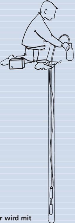
Ein Peilrohr wird mit der Wasserpumpe mit Verbrennungsmotor gereinigt.
