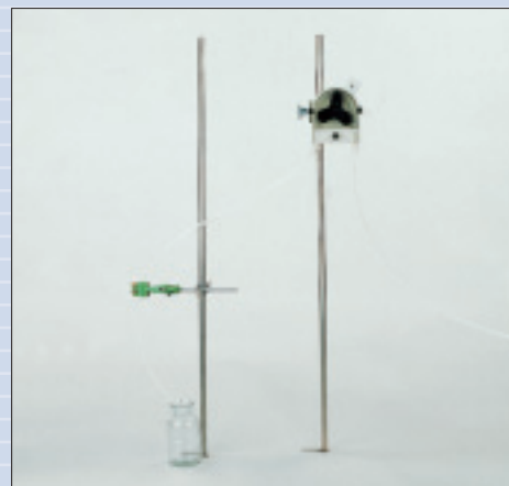
Schlauchquetschpumpe mit „dritter Hand“
