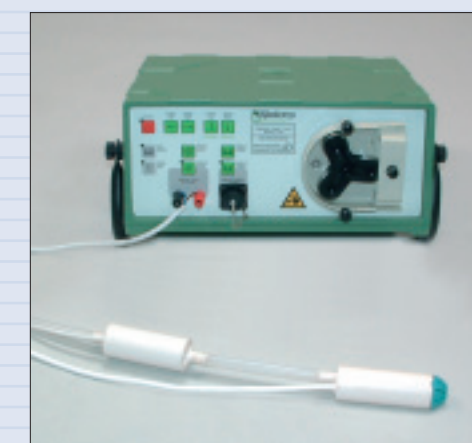
Schlauchquetschpumpe mit Tauchpumpen
