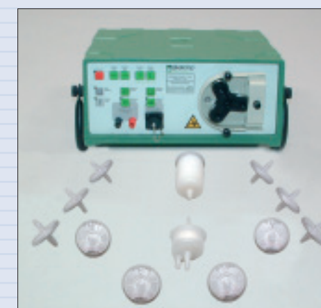
Schlauchquetschpumpe mit Einwegfilter
