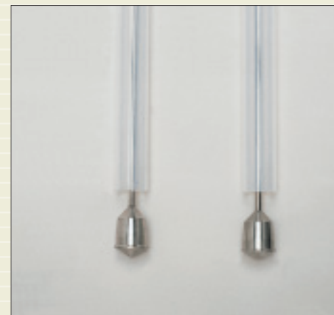
Proberohre mit unterem Stöpsel
