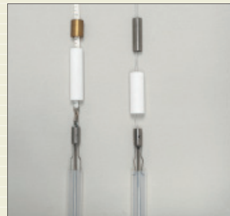
Proberohre mit Fallgewicht
